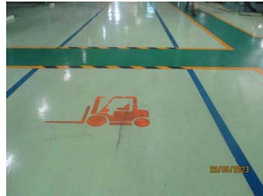
รูปที่ 3-47 การแบ่งเส้นทางขนส่งโดยรถโฟล์คลิฟต์ แยกจากเส้นทางเดินของพนักงาน
