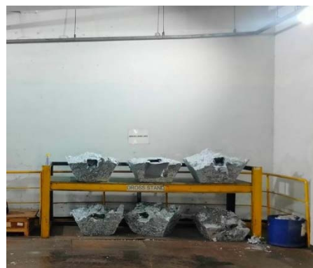
รูปที่ 3-22 ภาพขณะและพื้นที่เก็บรวบรวม กากตะกอนสังกะสี
